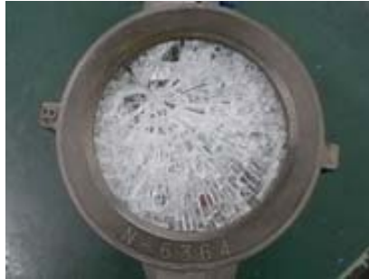
凍結破損のメーター表示部
